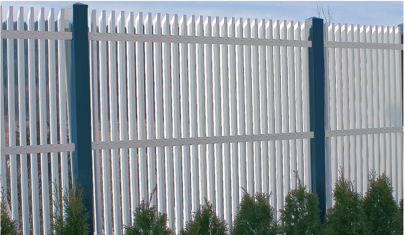
Fertig vormontierte Zaunfelder unten und oben schräg geschnitten. Für Gurte ausgeklinkt. Latten unten ohne, oben mit Kappe, auf Alu-Riegel aufgeschraubt. Lattenabstand 4 – 4,5 cm, Latten (25 x 80 mm), Ansicht Schmalseite.
